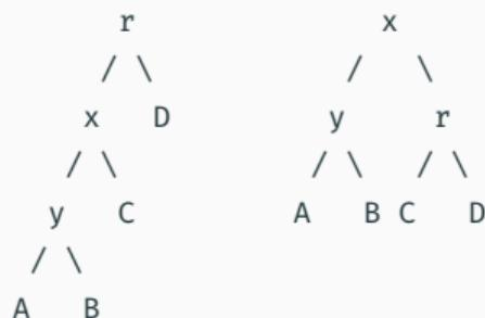
Note que a árvore fica com uma nova raiz e que a altura da subárvore a esquerda diminui e a altura da subárvore a direita aumenta.
