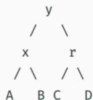
Note que a árvore tem uma nova raiz e que a altura da subárvore a esquerda diminuiu e a altura da subárvore a direita aumentou.
